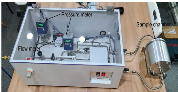
그림 3. UHPC 시편단위 기밀 시험 장치 및 인장 실험 과정
