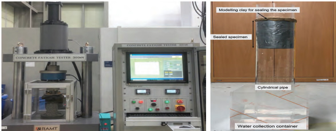
그림 7. 다공성 콘크리트의 피로시험 및 투수계수 측정
