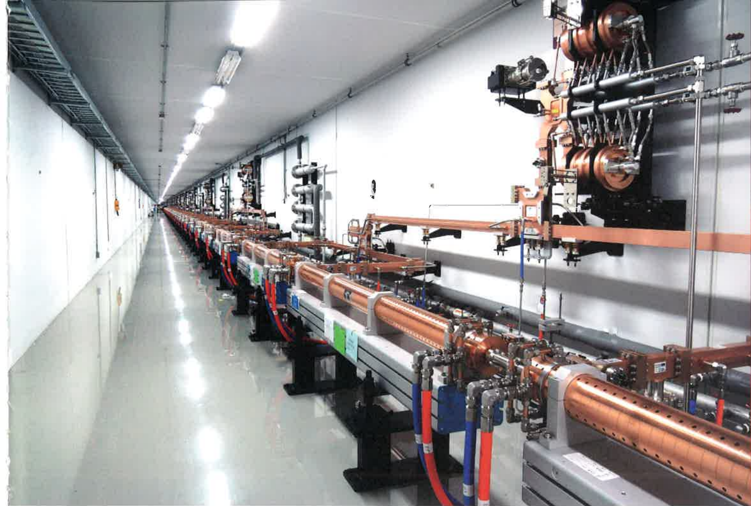
4세대 방사광가속기의 선형가속기 터널 내부에 설치된 가속장치. 전자총에서 나온 전자를 빛의 속도로 가속시켜 10GeV(기가전자볼트·1GeV는 10억eV)의 에너지를 가지게 하는 길이 780m의 장치다.
